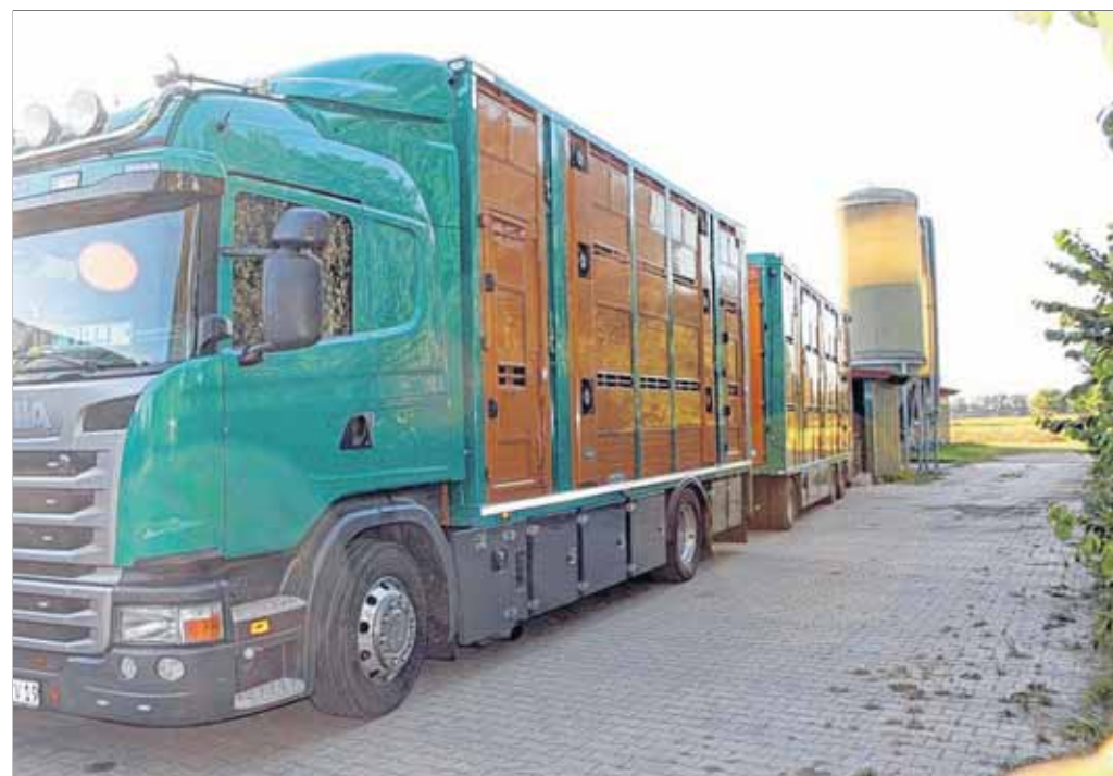
Sowohl Lkw als auch Anhänger können die Ferkel auf drei Ebenen transportieren.
